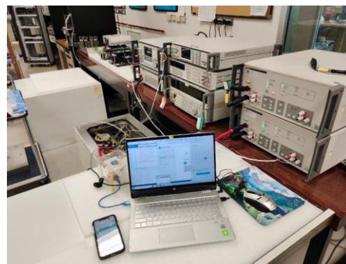
รูปที่ 7 การติดตั้งเครื่องมือเพื่อเก็บค่าอุณหภูมิและค่าความต้านทานขณะจ่ายกระแสไฟฟ้าค่าสูงถึง 10 A ผ่านตัวต้านทานมาตรฐาน
