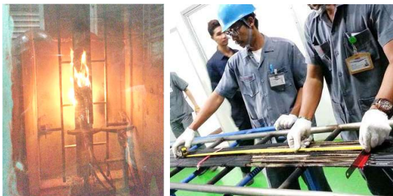
รูปที่ 6 ทดสอบตามมาตรฐาน IEC 60332-3-24 เป็นการทดสอบเผาไฟแนวดิ่ง
