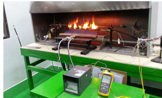
รูปที่ 7 ทดสอบตามมาตรฐาน IEC 60331-21 เป็นการทดสอบเผาไฟแนวนอน
