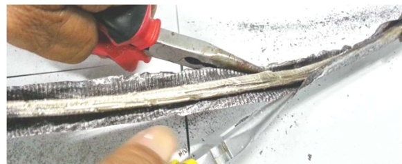
รูปที่ 13 สาย OFC ทนไฟเส้นแบบเวอร์ชัน 4 ผ่านการทดสอบไฟ
