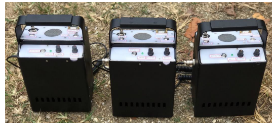
รูปที่ 4 เครื่องรับส่งวิทยุแอนะล็อกแบบโหมดเดี่ยวความถี่ 3 MHz
