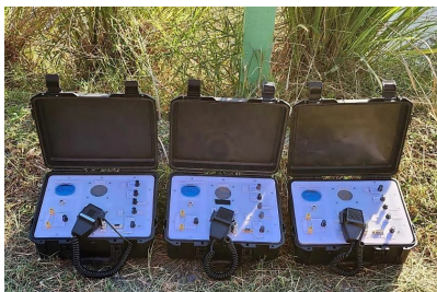
รูปที่ 3 เครื่องรับส่งวิทยุแอนะล็อกแบบหลายโหมดความถี่ 350 kHz
