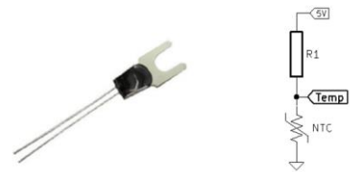
รูปที่ 6 เซ็นเซอร์วัดอุณหภูมิ NTC และการต่อใช้งาน
