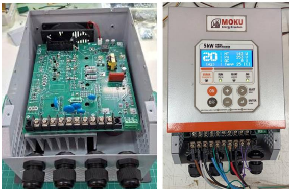
รูปที่ 14 การประกอบแผงวงจรลงกล่องและผลิตภัณฑ์ที่สำเร็จ
