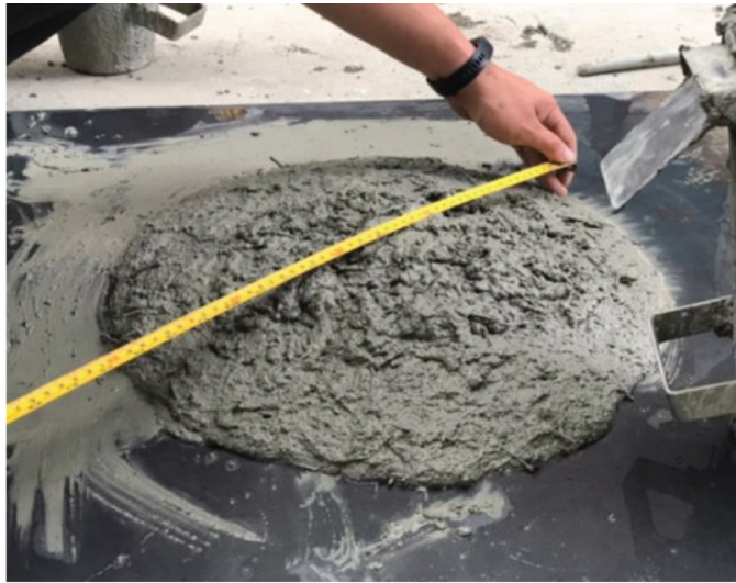
รูปที่ 4 ตัวอย่างการทดสอบการไหลแผ่ของมอร์ตาร์เสริมเส้นใยพอลิโพรไพลีนที่ไม่เกิดการแยกตัว
