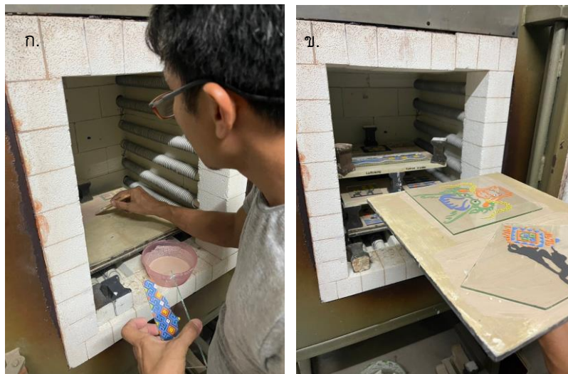
ภาพที่ 13 การวางตำแหน่งของชั้นวางเผา (Shelf) จัดเรียงขาตั้งวางเผา (Stack) สำหรับชั้นวางเผา การทาวัดอุณหภูมิวัสดุ ประเภททนไฟบนชั้นวางเผา (Kiln Wash) สำหรับป้องกันการติดของแผ่นแก้ว จากนั้นจึงเรียงชั้นงานเข้าเตาเผา (ภาพโดยผู้วิจัย)
