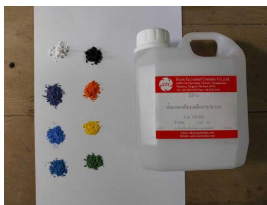
ภาพที่ 9 มีเดียม น้ำยาในการผสมสีผงให้เป็นของเหลว (ภาพโดยผู้วิจัย)
