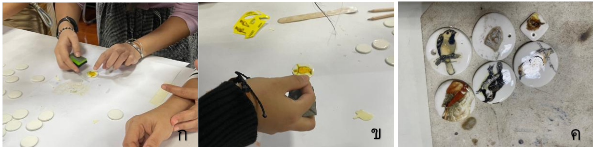
ภาพที่ 10 (ก-ค) แสดงขั้นตอนการติดรูปลอกเซรามิกส์ (ภาพโดยผู้วิจัย)
