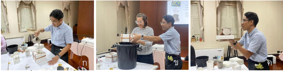
ภาพที่ 12 (ก-ค) แสดงขั้นตอนการหล่อกลองด้วยแม่พิมพ์ปูนปลาสเตอร์ (ภาพโดยนางสาวปรารถนา มีโค)
