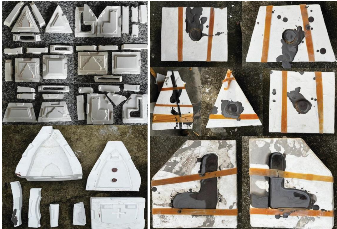
รูปที่ 13 แม่พิมพ์ปูนปลาสเตอร์และการหล่อน้ำดิน
