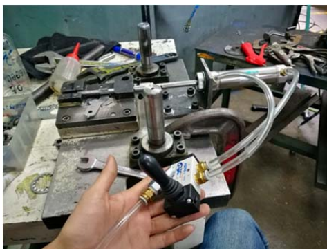
ภาพที่ 4 การติดตั้งชุดวาล์วควบคุมทิศทางพร้อมกับอุปกรณ์ตัวกระบอกลม
