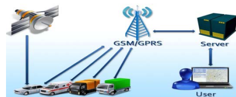
ภาพที่ 7 ลักษณะการทำงานของระบบ GPS
