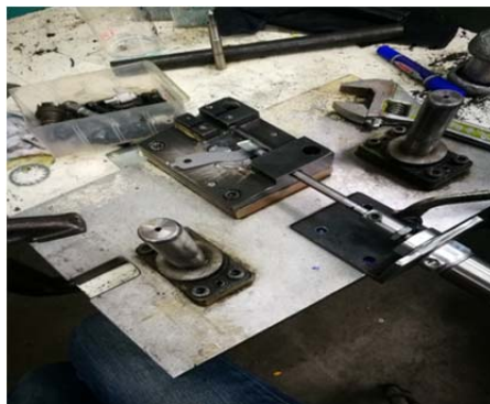
ภาพที่ 2 การนำตัวล็อกชิ้นงานมาล็อกกับโต๊ะงาน
