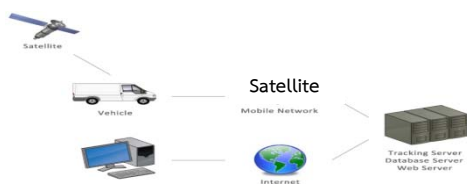
ภาพที่ 9 แสดงถึงหลักการทำงานของ GPS Tracking System แบบ Real Time EDI (Electronic Data Interchange)
