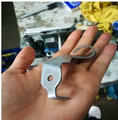
ภาพที่ 6 ภาพชิ้นงานม้วนกลมที่ได้จากเครื่องปั๊มโลหะ
