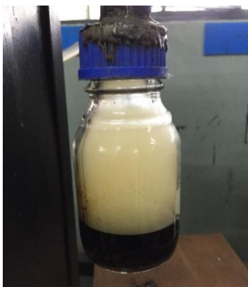
ภาพที่ 4 ลักษณะของตัวอย่างน้ำมันชีวภาพที่ได้จากการควบแน่นไอน์ไพโรไลซิสในเครื่องปฏิกรณ์แบบตกอิสระ
