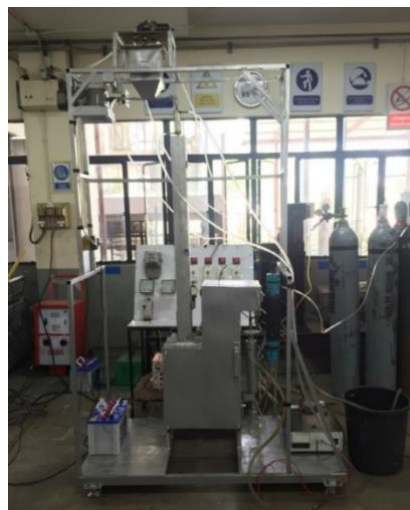
ภาพที่ 2 หน่วยผลิตไพโรไลซิสแบบเร็วที่ใช้เครื่องปฏิกรณ์แบบตกอิสระสำหรับการใช้ใ้ในการศึกษา
