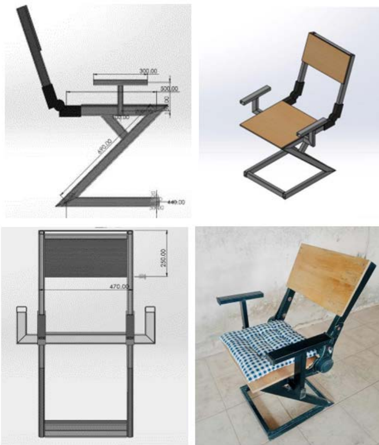
ภาพที่ 8 การออกแบบและสร้างเก้าอี้นั่งทำงาน
