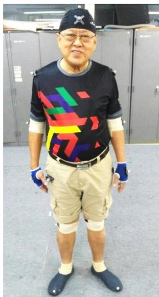
ภาพที่ 4 แสดงตัวอย่างการติด Marker เพื่อใช้งานอุปกรณ์ Motion Capture
