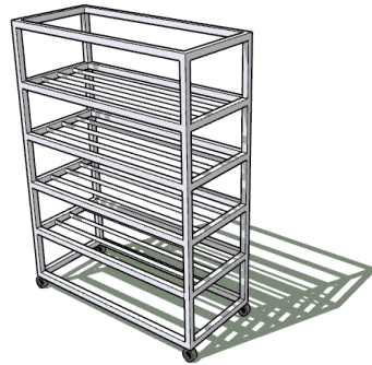
ภาพที่ 3 การออกแบบและพัฒนาชั้นวางช่องลมตู้แช่
