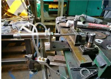
ภาพที่ 3 การนำกระบอกลมติดกับตัวล๊อคอุปกรณ์เสริมของตัวกระบอกลม
