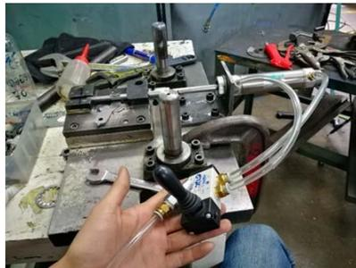
ภาพที่ 4 การติดตั้งชุดวาล์วควบคุมทิศทางพร้อมกับอุปกรณ์ตัวกระบอกลม
