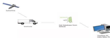
ภาพที่ 8 แสดงถึงหลักการทำงานของ GPS Tracking System แบบ Non Real Time
