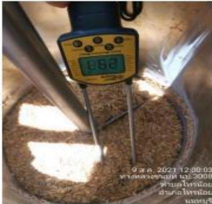
ภาพที่ 16 การวัดค่าความชื้นและจุดบันทึกผลการทดสอบในเครื่องอบแห้งข้าวกรณีเปิดมอเตอร์ใบกวนและฮีตเตอร์
