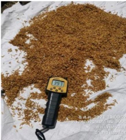
ภาพที่ 11 การวัดค่าความชื้นและจดบันทึกผลการทดสอบ
