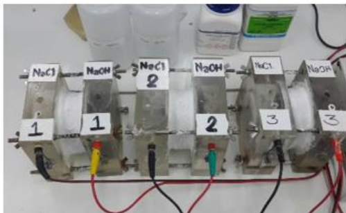
a) นำชิ้นตัวอย่างประกอบเข้ากับชุดทดสอบ
