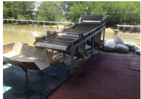
ภาพที่ 2 เครื่องคัดแยกขนาดหอยแครง
