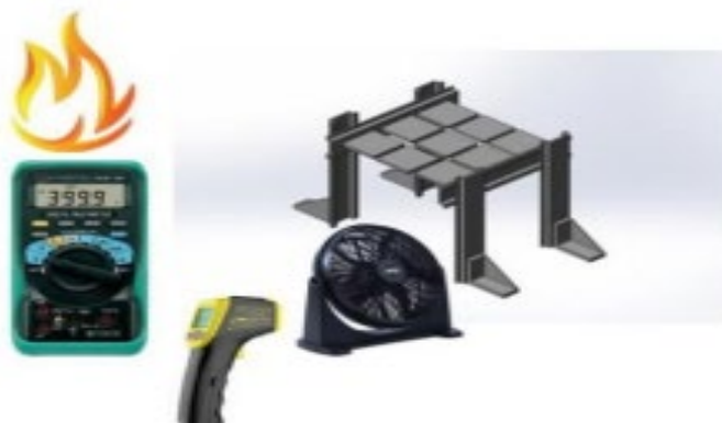
ภาพที่ 13 วัดแรงดันไฟฟ้าจากความร้อนโดยมีพัดลมระบายความร้อน
