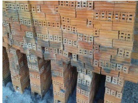
ภาพที่ 7 ลักษณะอิฐที่มีคราบรอยไหม้/รอยเขม่าและลักษณะอิฐผิดรูป (บิดงอ/แตกร้าว)
