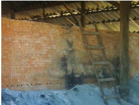
ภาพที่ 7 ลักษณะอิฐที่มีคราบรอยไหม้/รอยเขม่าและลักษณะอิฐผิดรูป (บิดงอ/แตกร้าว)
