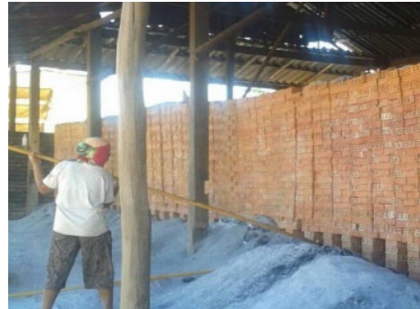
ภาพที่ 11 อิฐที่ผ่านกระบวนการเผาด้วยแผ่นผนังเตาแบบปรับปรุง
