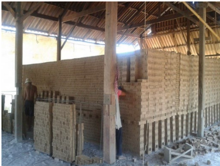
ภาพที่ 4 การเรียงอิฐดิบขึ้นเตา
